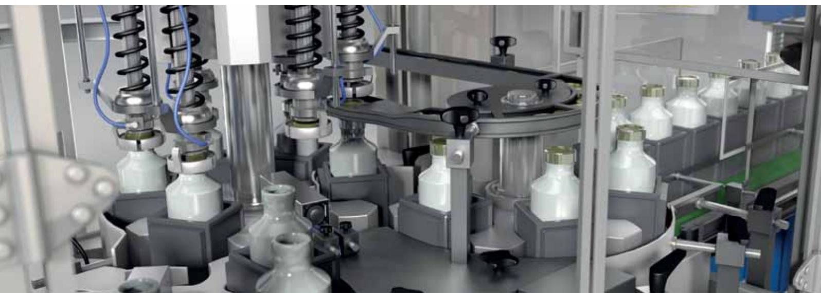
Moderne Hochleistungsverschließmaschinen zeichnen sich durch eine hohe Flexibilität beim Verschließen unterschiedlicher Behälterformen aus. Der Verschließvorgang erfolgt dazu getaktet oder kontinuierlich. Die Maschinen verschließen automatisch vielfältigste Aufdrück-, Schraub- und Ausrichtverschlüsse wie beispielsweise Gummistopfen, Lyostopfen, Tropfeinsätze, Schraubverschlüsse, Aufpressverschlüsse, Bördelkappen, Pipettenverschlüsse, Pilferproofkappen, Dosier- und Sprühpumpen.
