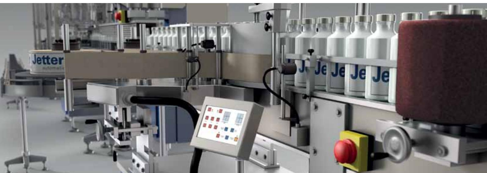
Runde Behälterformen und Sonderformen wie Flaschen oder Tuben bedeuten eine hohe Herausforderung für die Automatisierung von Etikettiermaschinen. Hierbei werden häufig umlaufende und an Design und Größe angepasste Etiketten aufgebracht, was einen speziellen Aufbau der Maschinen erfordert. Die Umrüstung des Systems soll gleichzeitig schnell möglich sein, um flexibel auch die Etikettierung von kleinen und mittleren Stückzahlen zu realisieren.
